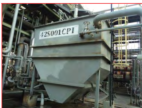
ภาพที่ 2.2-6 บ่อพักน้ำเสีย CPI (ADU)
